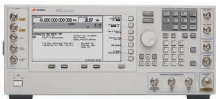
Векторный генератор СВЧ сигналов E8267D PSG от 100 кГц до 44 ГГц
